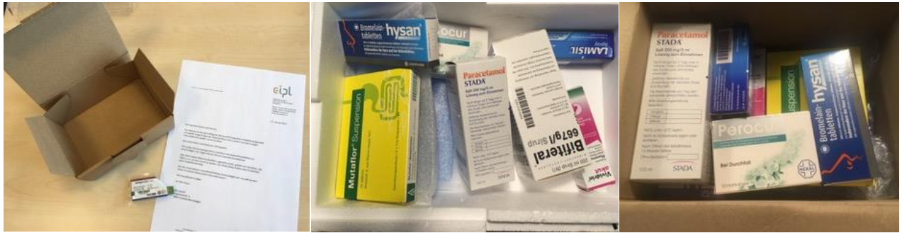
EIPL-Testpäckchen mit Datenlogger und Temperatursensor
